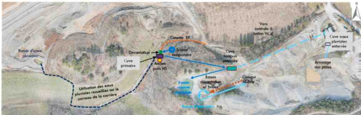
Figure 19 : Localisation et principe de fonctionnement du dispositif d'emploi et de recyclage des eaux de procédé (fond orthophoto 2020)
