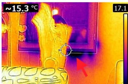
Exemple de fuites calorifiques (parties sombres) au niveau encadrement de fenêtre (photo ci-dessus) résolues par nouveau jointement silicone (photo ci-dessous)
